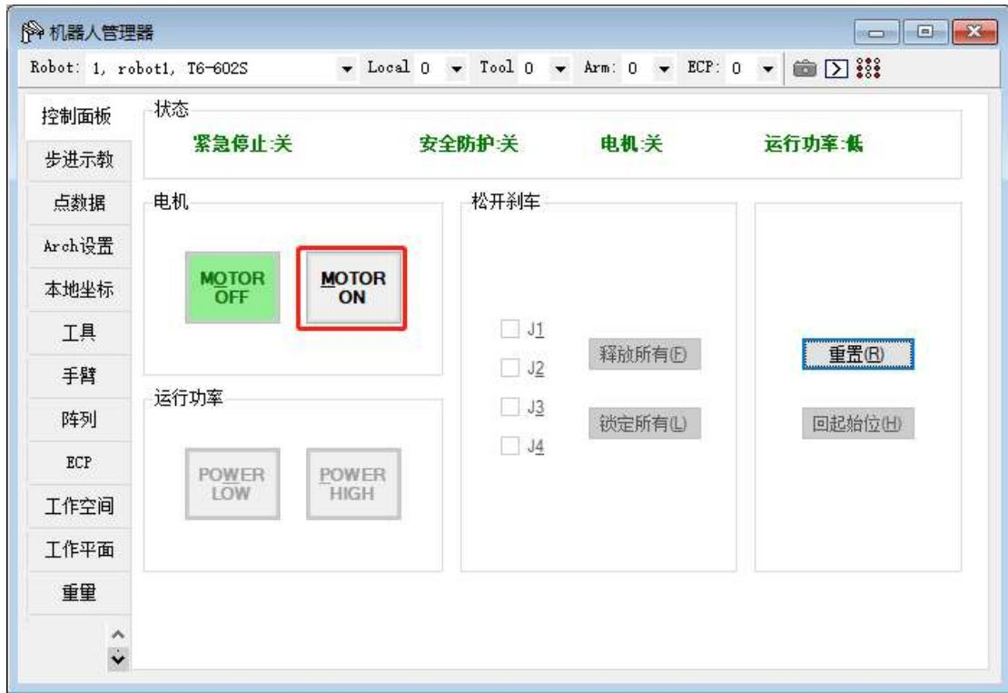
1 如果电机是关闭的状态 按 MOTOR ON 打开电机,若有故障 点击重置
